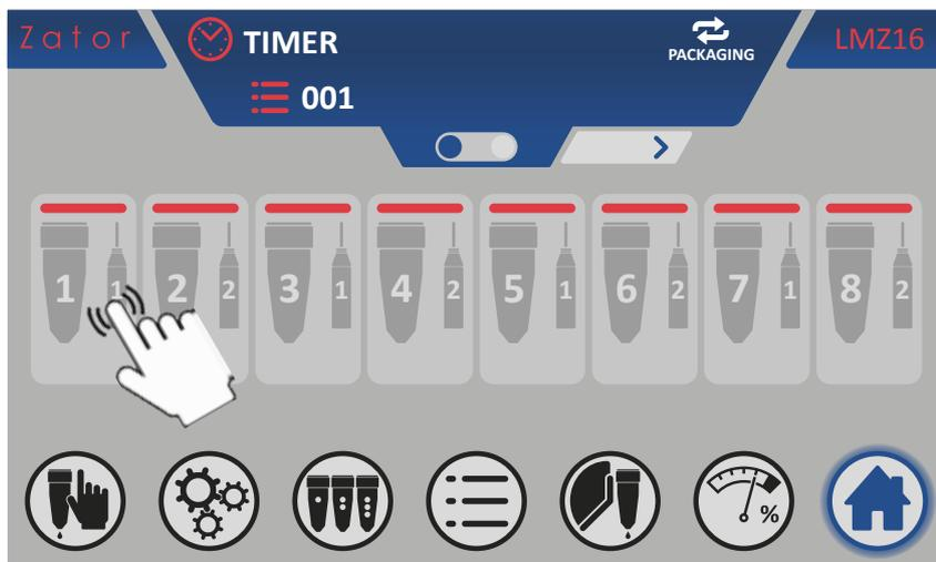
En fonction du type de valve attribuée (voir *paragraphe 9.1 - Modifier le type de valve attribuée*), il est possible d'afficher le **menu programmation segments colle pour valve goutte**<sup>6A</sup> ou le **menu programmation segments colle pour valves en forme de ligne**<sup>6B</sup> (voir page suivante).
