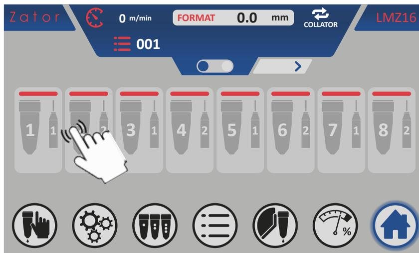
En fonction du type de valve attribuée (voir *paragraphe 9.1 - Modifier le type de valve attribuée*), il est possible d'afficher le **menu programmation segments colle pour valve goutte**<sup>51</sup> ou le **menu programmation segments colle pour valves en forme de ligne**<sup>51</sup> (voir page suivante).
