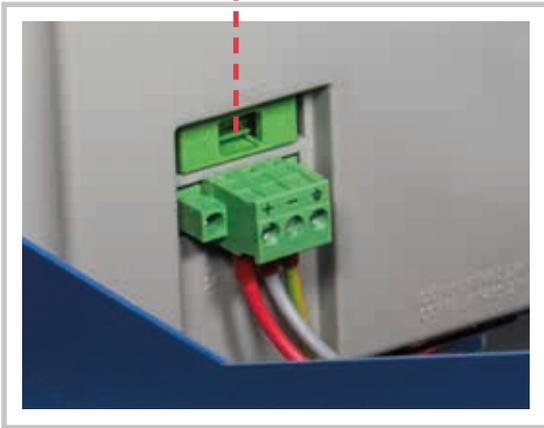
3. Extraire le *porte-fusible* de son logement et remplacer le fusible endommagé;
