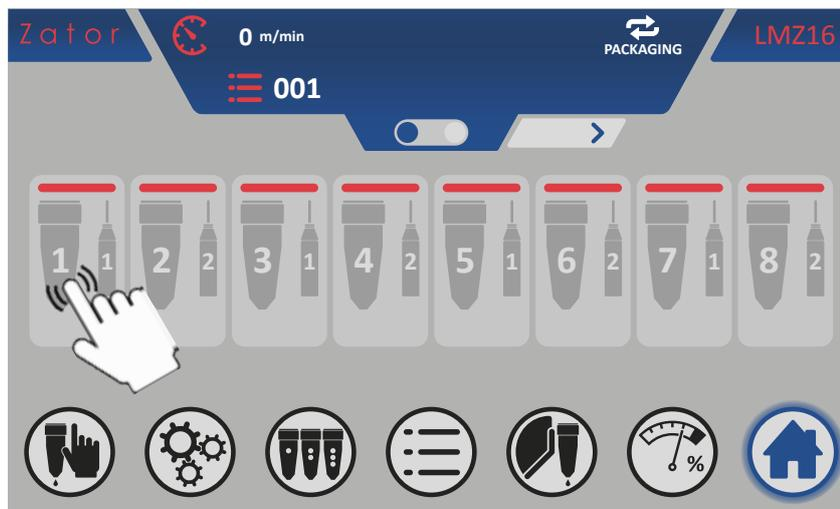
En fonction du type de valve attribuée (voir *paragraphe 8.1 - Modifier le type de valve attribuée*), il est possible d'afficher le **menu programmation segments colle pour valve goutte**<sup>5A</sup> ou le **menu programmation segments colle pour valves en forme de ligne**<sup>5B</sup> (voir page suivante).
