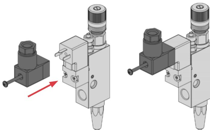
10 Avvitare la *vite* del connettore dell'elettrovalvola.
