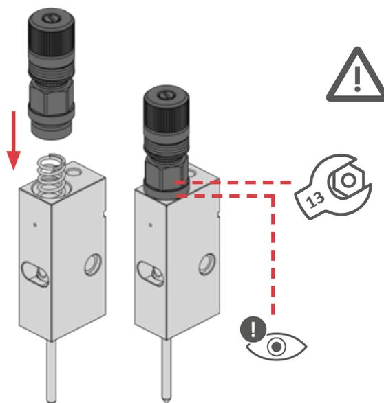
\***Prestare attenzione** che il blocco regolazione non sia inclinato durante l'avvitamento per evitare danni alla filettatura.
