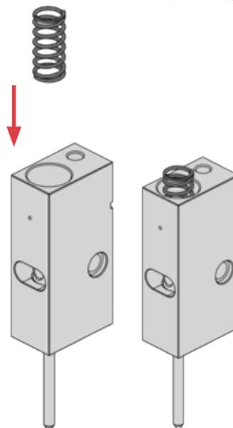
5 Avvitare\* il *blocco regolazione* nel corpo valvola con una chiave da 13;
