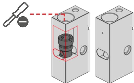
11 Controllare l'usura e lo stato degli *O-ring* (POS. 8-9-11) e della guarnizione sagomata (POS. 10) presenti sulla bussola e se necessario, sostituirli. Lubrificare\* sempre O-ring e guarnizione nuovi prima di montarli.
