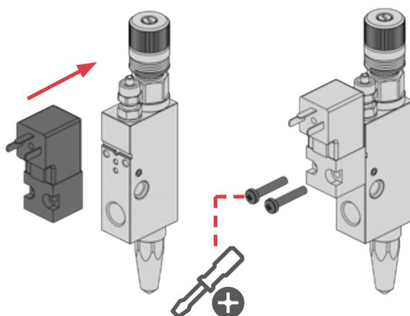
9 Infilare il *connettore dell'elettrovalvola*;
