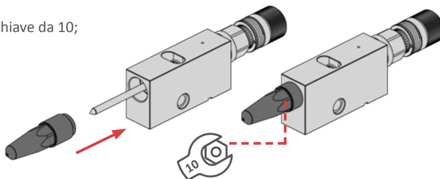
\*\***Prima di avvitare l'ugello**, verificare che la *manopola della regolazione micrometrica* sia completamente allentata per evitare di danneggiare l'ugello e lo spillo. Per allentare la manopola, ruotarla in senso antiorario finché non oppone più resistenza.
